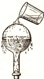
Abb. 149 Sieden des Wassers unter vermindertem Druck
