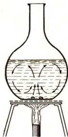
Abb. 70/1. Wärmeströmung in einer Kochflasche. In der Flasche entsteht eine Strömung, die in der Mitte aufsteigt und an der Glaswand absinkt. Sie wird durch Farbschlieren sichtbar gemacht.
