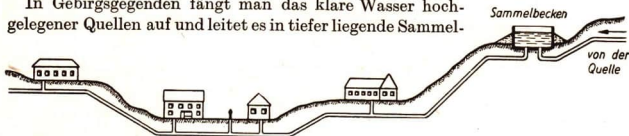
Abb. 36/1. Schematische Darstellung einer Gebirgswasserleitung
