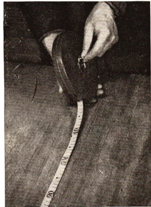
Abb. 13/2. Technisches Meßband. Es ist in einer Lederkapsel untergebracht und wird mit Hilfe einer Kurbel aufgewickelt.
