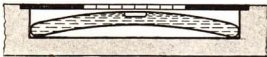
Abb. 34/2. Wasserwaage (schematisch). Das Röhrchen ist übertrieben stark gekrümmt, damit die Einstellung der Luftblase auf die höchste Stelle besser hervortritt.
