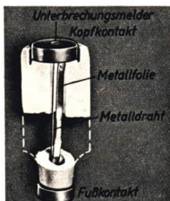
Abb. 72. Geöffneter Schmelzeinsatz. Man sieht neben der Metallfolie noch einen sehr dünnen Draht, der ein in die Kopfplatte eingebettetes Metallplättchen festhält. Er schmilzt gleichzeitig mit der Metallfolie durch.
