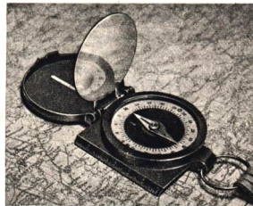
Abb. 21. Marschkompaß. Er enthält die Kompaßnadel in einem rechteckigen Gehäuse mit aufgesetzter, drehbarer Strichteilung. Der Deckel des Kompasses ist zu einer Visiereinrichtung ausgestattet. In einem aufklappbaren Spiegel kann beim Visieren gleichzeitig die Stellung der Kompaßnadel beobachtet werden. Der abgebildete Kompaß ist mit einer Zehnerskala versehen.
