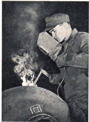
Abb. 69. Elektroschweißen eines Kesselbodens im EKM Dampfkesselbau Meerane VEB nach dem durch den Schweißingenieur Gerhard Bauch entwickelten Bündelschweißverfahren. Statt eines einzelnen dicken Eisendrahtes wird ein Bündel dünner Eisendrahte verwendet. Hierdurch wird das zur Verfügung stehende Material besser ausgenutzt. Der Schweißer blickt durch eine davorgehaltene Kappe. Diese enthält zum Verhüten der Blendung eine Scheibe aus dunkelblauem Glas.
