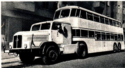
Abb. 268. Sattelschlepp-Omnibus in Berlin, hergestellt im IFA-Kraftfahrzeugwerk Werdau „Ernst Grube“ VEB, Vierzylinder-Dieselmotor, Leistung 120 PS
