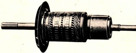
Abb. 190. Trommelanker mit Kollektor. In der Mitte der Ankerkörper, rechts der Kommutator, links der Lüfter
