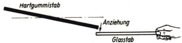
Abb. 107. Anziehung zwischen einem geriebenen Glasstab und einem geriebenen Hartgummistab. Versuchsanordnung von oben gesehen
