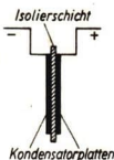
Abb. 111. Schnitt durch einen Plattenkondensator, dessen Platten durch eine Glasscheibe getrennt sind (schematisch)
