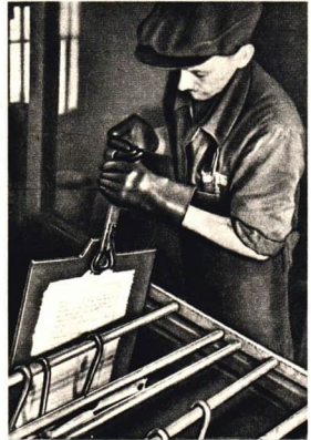
Abb. 88. Herausnehmen einer von einem Galvano überzogenen Matrize aus dem Galvanisierstrog. Der metallische Niederschlag ist deutlich erkennbar.
