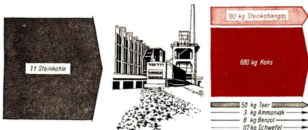
Abb. 67 Ausgangsstoffe und Endprodukte bei der Verkokung.
