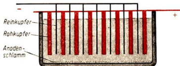
Abb. 180 Schematische Darstellung einer Kupferelektrolysezelle
