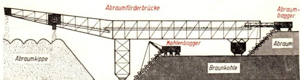
Abb. 47 Schematische Darstellung einer Abraumförderbrücke
