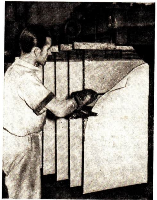
Abb. 181 Abtrennen der Elektrolytkupferhaut von den Kathoden
