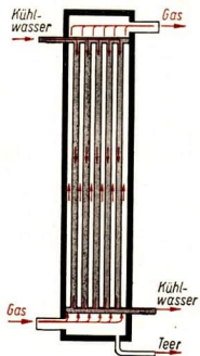
Abb. 59 Schematische Darstellung eines Röhrenkühlers
