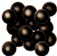
Räumliche Anordnung der Kohlenstoffatome im Atomkristall des Diamants
