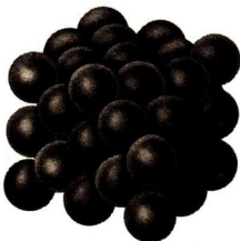
Räumliche Anordnung der Kupfer-Ionen im Metallkristall des Kupfers
