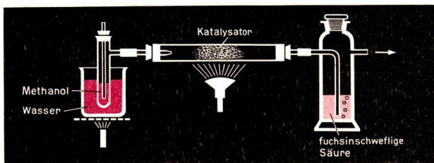
Abb. 24 Methanol wird katalytisch dehydriert.
