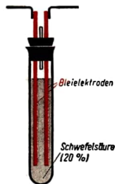
Abb. 73 Versuchsanordnung zur Wirkungsweise des Bleiakкумуляtors
