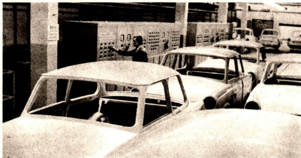
Abb. 48 Für die Außenverkleidung der Karosserie des PKW „Trabant“ wird ein Phenoplastpreßstoff verwendet.
