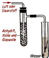
Abb. 131 Darstellung von Schwefeldioxid aus Anhydrit
