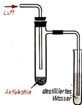
Abb. 117 Verbrennung von Kohlenstoff und Darstellung von Kohlensäure
