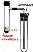
Abb. 130 Darstellung von Schwefeldioxid aus Sulfiten
