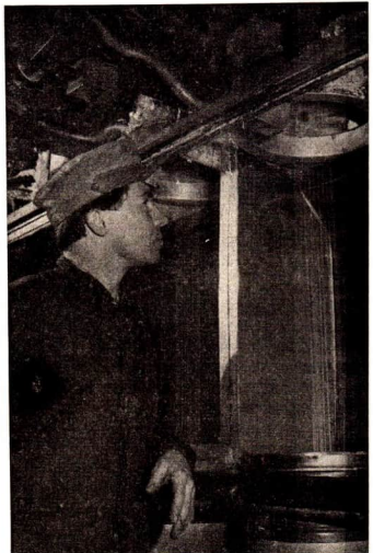
Abb. 122 Die Polykaprolaktamschmelze erstarrt an der Luft zu Dederonfäden
