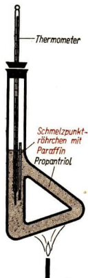
Abb. 166 Schmelztemperaturbestimmung von Kerzenparaffin (Durchführung b)
