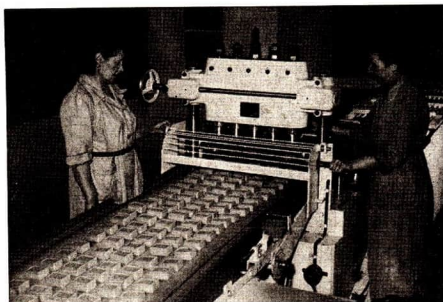
Abb. 91 In der Schlagpresse werden die Seifenstücke geprägt (Konsum-Seifenfabrik Riesa)
