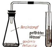
Abb. 152 Adsorption von Benzindämpfen durch Aktivkohle
