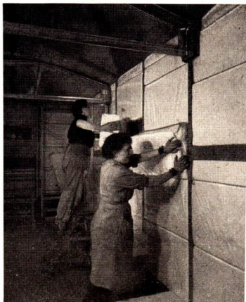
Abb. 114 Kühlwagen werden mit Piathermplatten ausgekleidet, die zum Schutz gegen Feuchtigkeit mit Perfol eingeschlagen sind
