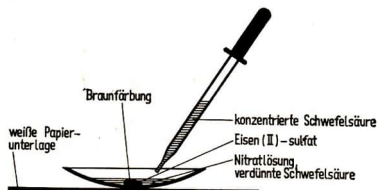
Abb. 81 Nachweis von Nitrat-Ionen (Halbmikrotechnik)
