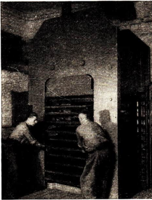
Abb. 105 Etagenpresse zur Herstellung von Schichtpreßstoffen im VEB Plasta Preßstoffwerk Köppelsdorf
