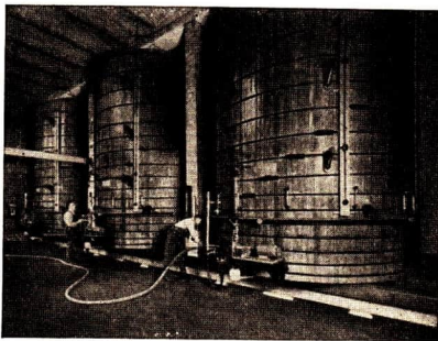
Abb. 49 Anlage zur Erzeugung von Gärungseisig in der Konsum-Essig- und Mostrichfabrik Berlin
