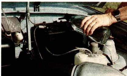
Abb. 27 Nachfüllen von destilliertem Wasser in eine Autobatterie
