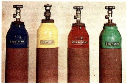
Abb. 65 Kennfarben für verschiedene Gase an Stahlflaschen
