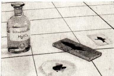
Abb. 89 Einwirkung von konzentrierter Schwefelsäure auf Papier, Holz und Leinwand
