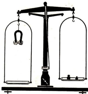
Abb. 15 Nachweis der Massenzunahme bei der Verbrennung
