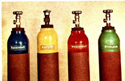
Abb. 21 Stahlflaschen für verschiedene Gase sind an charakteristischen Kennfarben zu unterscheiden.
