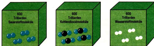
Abb. 41 Beziehung zwischen Anzahl der Teilchen und dem Volumen verschiedener Gase
