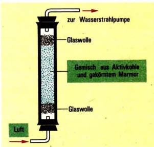
Abb. 61 Geräteanordnung zum Experiment 61
