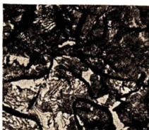
Abb. 12. Schliffbild von Grauguß in dreihundertfacher Vergrößerung. Die schwarzen Adern in der Grundmasse sind Graphit.
