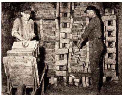
Abb. 30. Einsetzen des Brenngutes in den Ofen beim Schnellbrennverfahren.
