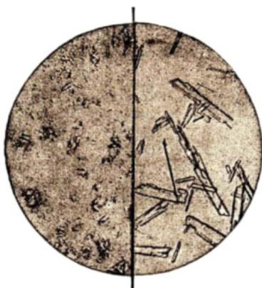
Abb. 70 Links Pulver von gebranntem Gips, rechts daraus entstandene Kriställchen. 360fache Vergr.
