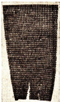
Abb. 91 Abbildung eines Gasglühstrumpfs, durch ausgesandte radioaktive Strahlung auf photographischem Papier entstanden
