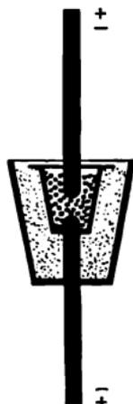
Abb. 100 Lichtbogenofen für Kalziumkarbid
