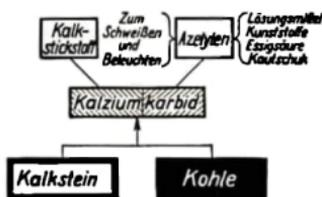
Abb. 102 Technische Bedeutung des Kalziumkarbids
