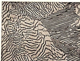
c. Perlit (dunkle Streifen von Ferrit in Zementit). Eutektikum
