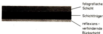
Abb. 50 Fotomaterial besteht aus mehreren Schichten.
