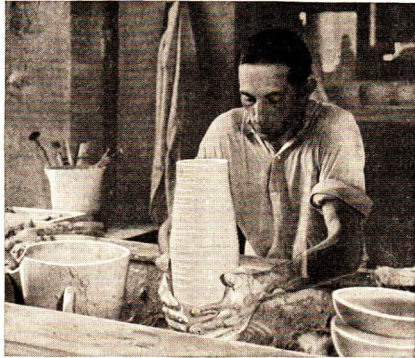
Abb. 46: Porzellandreherei. Aufdrehen eines Humbels (Rohform). (Staatliche Porzellanmanufaktur Meißen.)
