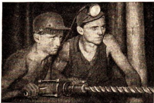
Abb. 64: Kohlengewinnung vor Ort mit dem Gesteinsbohrer.
