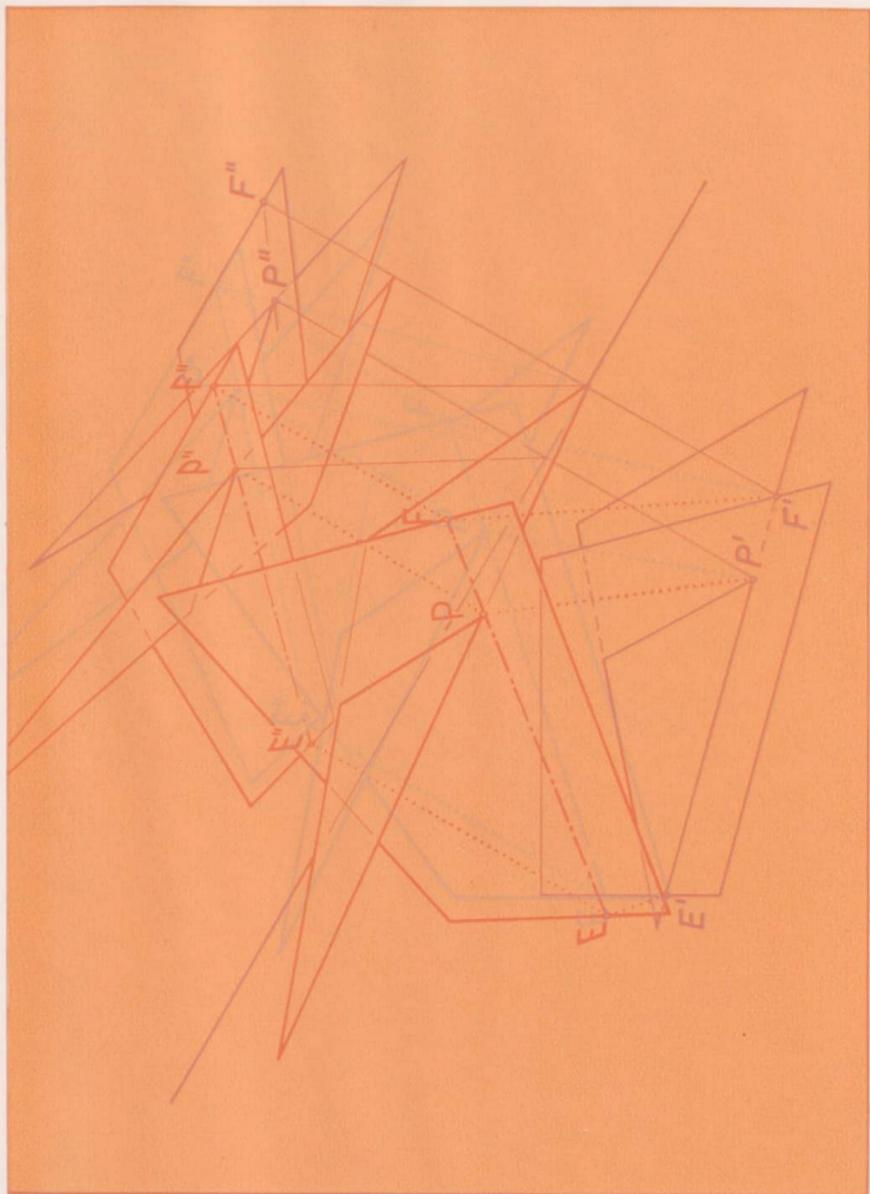
Tafel 11: Durchdringung eines ebenen Vierecks mit einem Dreieck, Kantenverfahren
