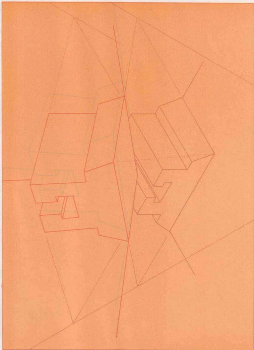
Tafel 29: Führungsteil einer Maschine in standardisierter Isometrie
