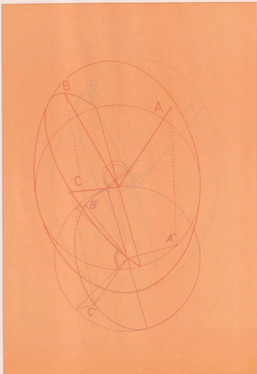
Tafel 31: Beliebige axonometrische Abbildung einer Kugel (Trimetrie)
