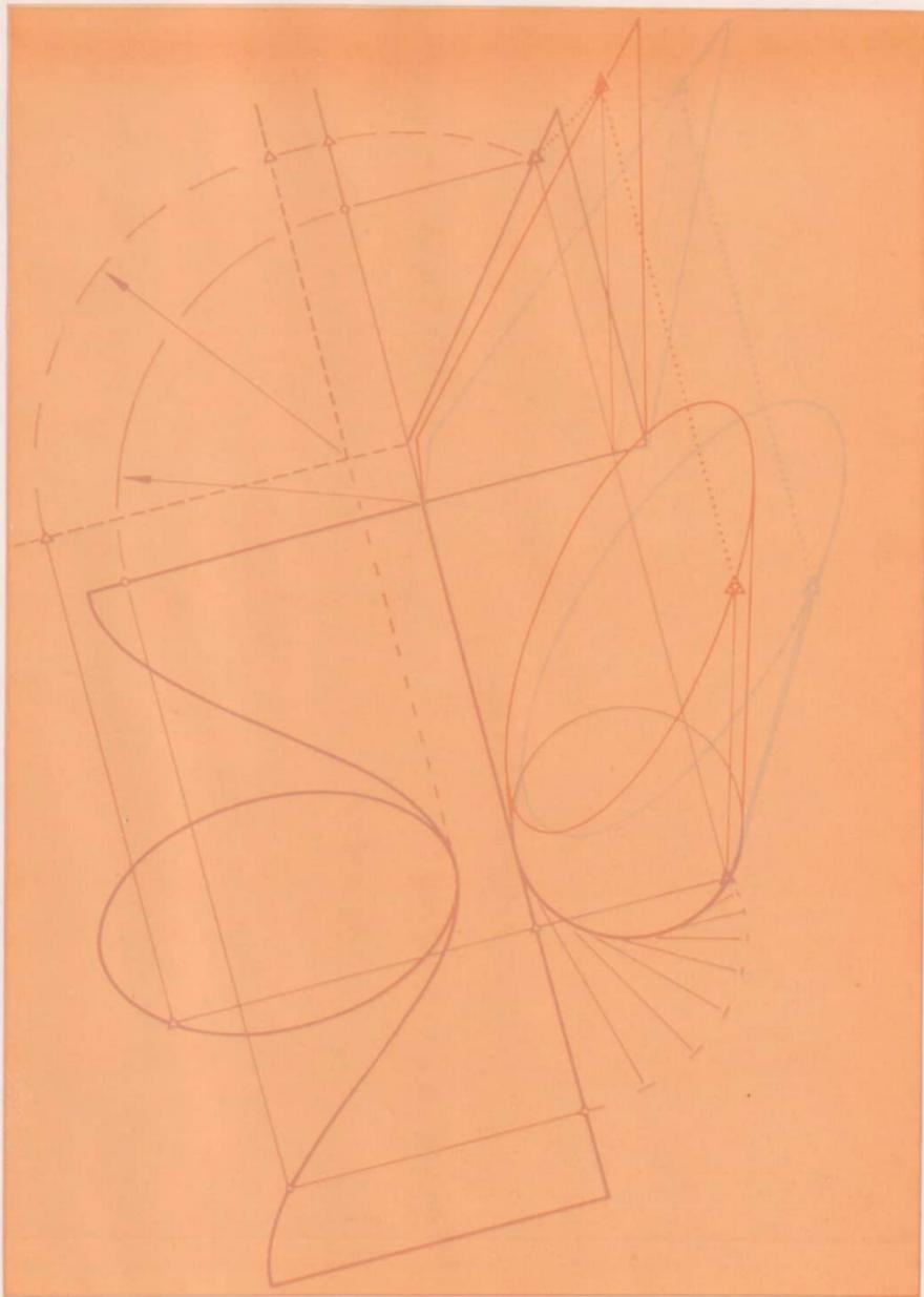
Tafel 15: Abwicklung des Mantels eines schräg abgeschnittenen Zylinders
