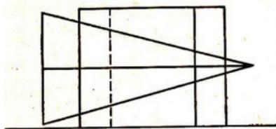
worden, so daß auch im Aufriß und Kreuzriß keine unsichtbaren Körperkanten eingezeichnet sind. Erst in den Umlegungen dieser beiden Risse sowie im Grundriß sind die unsichtbaren Kanten (als Strichlinien) eingetragen worden.
