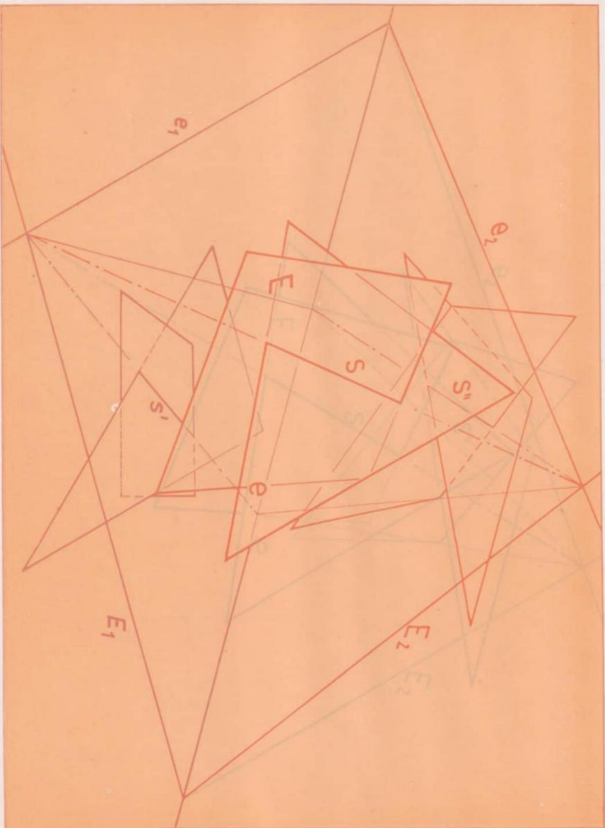
Tafel 12: Durchdringung eines ebenen Vierecks mit einem Dreieck, Ebenenverfahren
