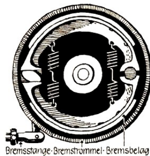
Schnitt durch eine Kraftfahrzeug-Bremstrommel
