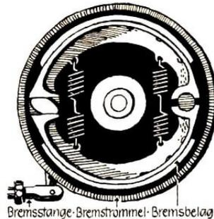
Schnitt durch eine Kraftfahrzeug-Bremstrommel
