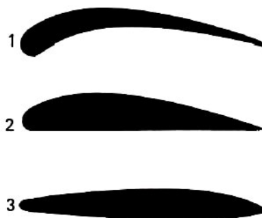
Bild 131: Flügelprofile für: 1 niedrige Fluggeschwindigkeit (Vogel, Flugmodell); 2 mittlere Fluggeschwindigkeit (Sportflugzeug); 3 hohe Fluggeschwindigkeit (Jagdflugzeug)
