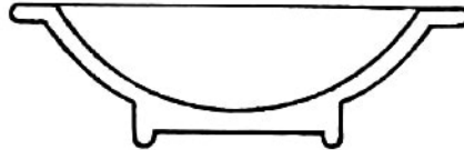
Bild 179: Schale zur Herstellung einer Eislinse
