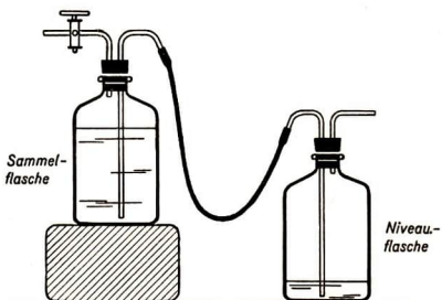
Abb. 23: Der aus Eisen und Wasser erzeugte Wasserstoff wird in einem Vorratsbehälter gesammelt.
