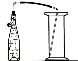
Abb. 39: Auffangen des im Selterswasser gelösten Kohlendioxyds.
