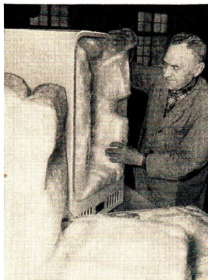
Abb. 99 Verwendung von Glaswolle zum Isolieren von Kühlschränken im VEB Glasfaserwerk Steinach
