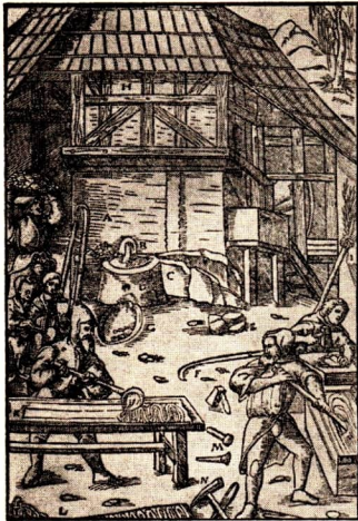
Bild 8/1 Zinnschachtlofen A mit Vorherd D Darstellung aus der Schrift „De re metallica“ von G. Agricola aus dem Jahre 1556
