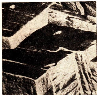
Bild 13/1 Elektronenmikroskopische Abbildung einer Aluminiumoberfläche mit würfelförmigen Kristalliten
