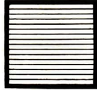
Abb. 124 Gitter zum Nachweis der Polarisation der Wellen
