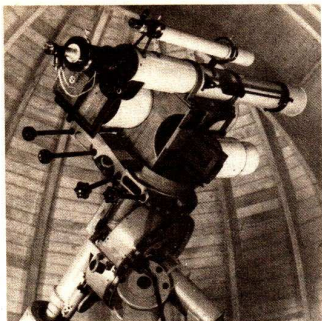
7/1 Fernrohr zur direkten (visuellen) Beobachtung mit zwei Fernrohren zur Himmelsfotografie
