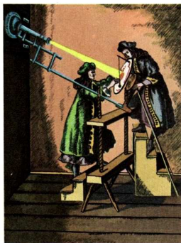
Mit Vorsicht ausgeführte (daher indirekte) Sonnenbeobachtung im Mittelalter. Dieselbe Methode wird noch heute, zum Beispiel in unseren Schulen, angewandt: Das Bild der Sonne erscheint hinter dem Okular auf einem Projektionsschirm und kann dort ohne Gefahr für die Augen betrachtet werden.
