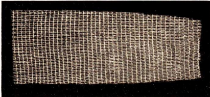
Abb. 175. Radiographie eines Glühstrumpfes. Wirkung der Strahlung von Thoriumoxyd auf eine photographische Platte
