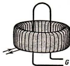
Abb. 80. In dieser Lage wird kein Strom induziert
