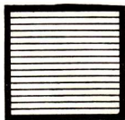
Abb. 312. Gitter zum Nachweis der Polarisation der Wellen
