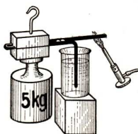
Abb. 169. Thermoelement als Stromquelle für einen Elektromagneten
