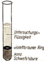
Abb. 106 Ringbildung beim Nachweis von Nitrationen mit Eisen(II)-sulfat
