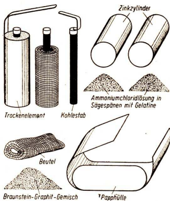
Abb. 58 Einzelteile einer Taschenlampenbatterie
