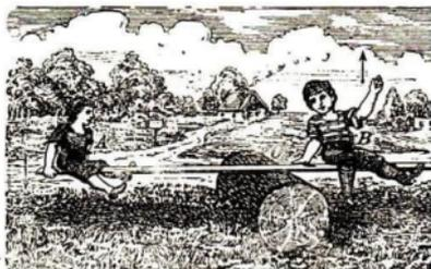
Abb. 81. Es kommt auf den Hebelarm an
