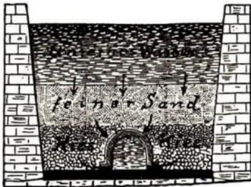
Abb. 419. Große Filteranlage
