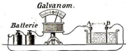
Abb. 336. Herstellung des Akkumulators
