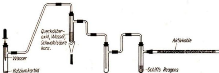
Abb. 91 Katalytische Wasseranlagerung an Äthin
