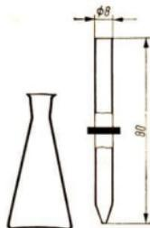
Schließlich gelingt der Nachweis der Brennbarkeit pneumatisch aufgefangener Gase in diesen Erlenmeyerkolben besser als in Halbmikro-Reagenzgläsern, da die Öffnung der Halbmikro-Reagenzgläser für das Durchschlagen der Flamme zu eng ist. Die enghalsige und die weithalsige Form der 25-ml-Erlenmeyerkolben können in gleicher Weise wie die 25-ml-Rundkolben benutzt werden ( $\nearrow$  S. 40).
