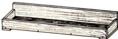
**Flaschenständer** werden neben Flaschengestellen zur Aufbewahrung der Chemikalienflaschen benutzt. Sie bestehen aus Holz oder PVC und haben folgende Abmessungen (Abb. 30): Länge 370 mm, Höhe der Hinterwand 38 mm, Höhe der Vorderwand 18 mm, Breite der Grundplatte 35 mm. Im Flaschenständer finden zehn Halbmikro-Standflaschen Platz. Die Flaschenständer werden eingesetzt, wenn die Flaschen außerhalb der Schülerarbeitsplätze aufbewahrt werden müssen (↗ S. 22).
