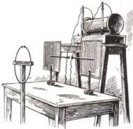
Der Oszillator von Hertz erzeugt elektromagnetische Wellen
