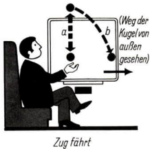
Für den Fahrgast fällt die Kugel im Abteil des gleichmäßig geradeaus fahrenden Zuges senkrecht herunter (a); für den Außenstehenden beschreibt sie eine Parabel (b)
