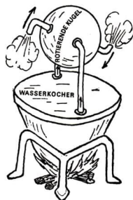
Hérons Dampfkeisel, ein Vorläufer der Dampfmaschine
