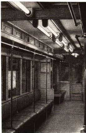
Abb. 127/1. Ein mit Leuchtstofflampen beleuchteter U-Bahn-Wagen
