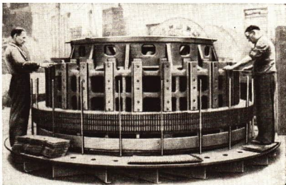
Abb. 49/1. Montage eines großen Trommelankers
