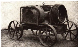
Abb. 81/2. Schwerer landwirtschaftlicher Elektromotor auf einem Motorwagen
