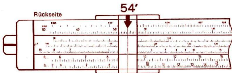
Läufer stehen lassen, Rechenstab umdrehen und unter Mittelstrich des Läufers auf Grundteilung VI ablesen.
