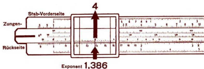
Das Radizieren mit der logarithmischen Basis  $e = 2,71828 \dots$
