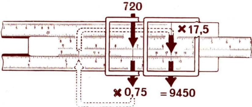
Rechnungsfolge: Läuferstrich über 7 5 von Skale VI; 720 von Reziprokteilung unter Läuferstrich, Läuferstrich über 17,5 von Skale V; Resultat auf Skale VI unter Läuferstrich ablesen.
