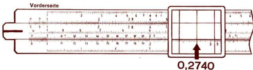
Glasläufer stehen lassen und auf der Rückseite des Rechenschiebers auf Skale VIII unter Läuferstrich ablesen.
