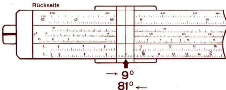
Läufer stehen lassen, Rechenstab umdrehen und unter Mittelstrich des Läufers auf Grundteilung VI ablesen.
