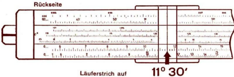
Läufer stehen lassen, Rechenstab umdrehen und unter Mittelstrich des Läufers auf Grundteilung VI ablesen.
