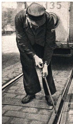
Abb. 131. Weichenstellhebel der Straßenbahn
