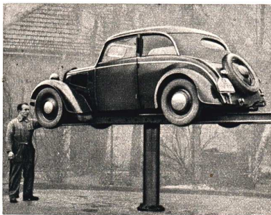
Abb. 95. Hydraulischer Wagenheber Durchmesser der Drucksäule 25,2 cm, Querschnitt der Drucksäule 500 cm 2 , Flüssigkeitsdruck 6 at
