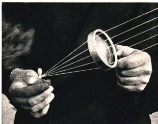
Abb. 34. Die durch eine Sammellinse fallenden Sonnenstrahlen entzünden eine in den Brennpunkt gehaltene Streichholzkupe. Die im Bild sichtbaren „Lichtstrahlen“ sind nachträglich eingezeichnet.
