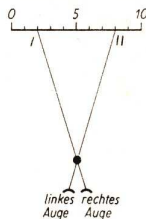
Abb. 49. Scheinbare Verschiebung eines Gegenstandes vor dem Hintergrund. Das rechte Auge sieht den Gegenstand bei I, das linke Auge bei II.
