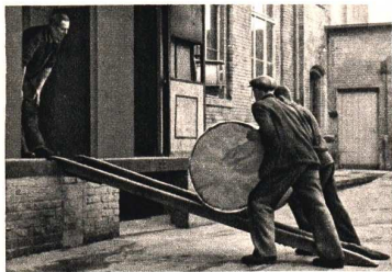
Abb. 165. Die Schrotleiter als Beispiel einer schiefen Ebene
