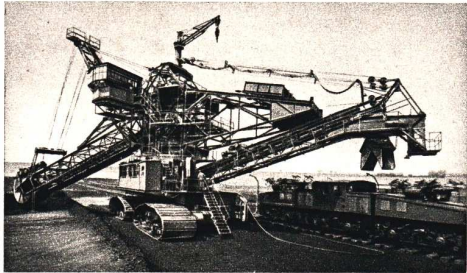
Abb. 91. Schaufelradbagger in einer Braunkohlengrube beim Abtragen der Kohle
