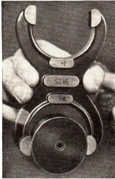
Abb. 11. Rachenlehre zum Überprüfen des Durchmessers zylinderförmiger Werkstücke
