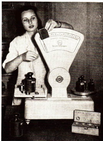
Abb. 18. Bestimmen der Empfindlichkeit einer Zeigerschnellwaage im Deutschen Amt für Maß und Gewicht (DAMG). Ein kleines Gewichtsstück, das an einem Faden hängt, wird auf die belastete Waagschale gelegt und wieder abgehoben. Die prüfende Assistentin beobachtet den abgewandten Zeiger in einem Spiegel.
