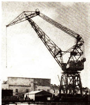
Abb. 50. Portal-Wipp-Drehkran, hergestellt vom VEB Kranbau, Eberswalde. Tragfähigkeit 6 Mp, maximale Höhe 42 m, maximale Ausladung 24 m. Die Veränderlichkeit der Ausladung wird durch ein Gelenkviereck erreicht.
