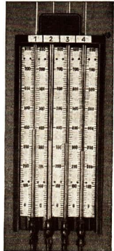
Abb. 151. Flüssigkeitsmanometer in einem Gaswerk
