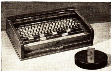
Abb. 10. Parallelendmaße aus dem Carl-Zeiss-Werk VEB Jena. Sie werden satzweise in Schutzkästen aufbewahrt. Die im Bild schwarz erscheinenden Körper sind die Endmaße.
