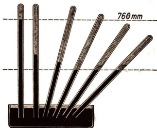
Abb. 247. Ungesättigter Dampf im Vakuum
