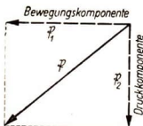
Abb. 44. Rasenmäher im Gebrauch. Darunter das Schema der Kraftzerlegung
