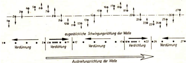
Abb. 21/1. Punktreihe als Bild einer Longitudinalwelle Darüber das Bild der Transversalwelle, aus der die Longitudinalwelle abgeleitet wurde.
