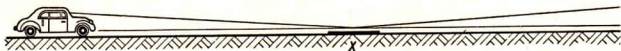
Abb. 85/1. Luftspiegelung auf der Landstraße. Der Fahrer sieht bei x scheinbar eine Wasserfläche.
