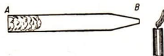
Abb. 45/1. Ausbreitung eines Luftstoßes in einem Rohr. Die Luftteilchen geben den Impuls weiter. Die Luftmasse als Ganzes bewegt sich aber nicht vorwärts.
