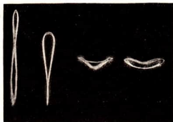
Abb. 97/2. Entstehung der Koma durch Randstrahlen bei schiefem Strahleneinfall
