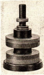
Abb. 215/1. Dauerabstimmung zwischen zwei Paaren ringförmiger keramischer Magnete. Die abstoßende Kraft hält in jedem Paar den oberen Magnet entgegen der Schwerkraft in der Schwebe. Die in der Mitte stehende Säule dient nur zur Führung.
