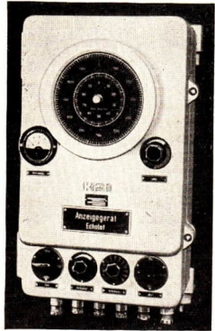
Abb. 48/1. Echolotgerät, hergestellt vom volkseigenen RFT-Funkwerk Berlin-Köpenick. Das Gerät steht im Beobachtungsstand des Schiffes. Es enthält zwei Skalen für Feinmessung und für Grobmessung, auf denen die Wassertiefe unmittelbar abgelesen wird.
