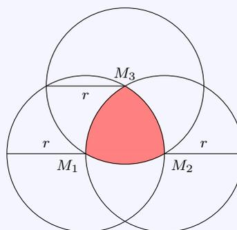
Berechnen Sie die Fläche, das Volumen und das Gewicht eines Stanzbleches von 3 mm Dicke der abgebildeten (farbigen) Form. Der Radius  $r$  beträgt 20 mm,  $\gamma = 7,8 \text{ p-cm}^{-3}$ .
