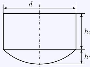
Der im Schnitt abgebildete Blechbehälter (Hohlzylinder mit aufgesetzter Kugelkappe, Abbildung) soll durch Tiefziehen aus einer Blechscheibe hergestellt werden.
