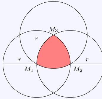
Berechnen Sie die Fläche, das Volumen und das Gewicht eines Stanzbleches von 3 mm Dicke der abgebildeten (farbigen) Form. Der Radius  $r$  beträgt 20 mm,  $\gamma = 7,8 \text{ p}\cdot\text{cm}^{-3}$ .
