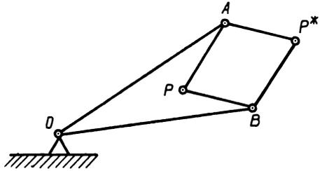
Es sei  $OA > AP$ . Man denke sich den Punkt O in der Ebene drehbar fixiert und zeige, daß das Produkt der Entfernungen  $OP = r$  und  $OP^* = r^*$  eine von der Stellung des Mechanismus unabhängige Konstante ist.
