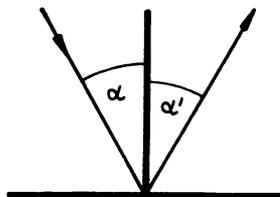
Fällt ein Lichtstrahl auf einen ebenen Spiegel, so wird er so reflektiert, daß der Einfallswinkel  $\alpha$  und der Reflexionswinkel  $\alpha'$  gleich groß sind.
