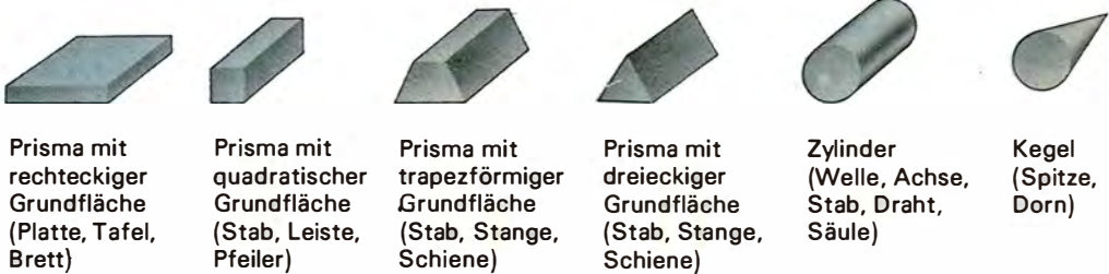
Bild 19.3. Geometrische und technische Formbegriffe
