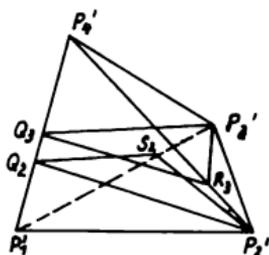
Man teile die Strecke  $P'_1P'_4$  im Verhältnis  $d_1 : d_2 : d_3$  und erhält die Teilpunkte  $Q_2, Q_3$  auf  $P'_1P'_4$ . Teilung der Strecken  $P'_2P'_4$  im Verhältnis  $d_2 : d_3$  und  $P'_1P'_3$  im Verhältnis  $d_1 : d_2$  führt zu den Teilpunkten  $R_3$  und  $S_2$ .
