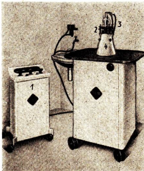
Abb. 132/2. Feinstruktur-Untersuchungsgerät des VEB Transformatoren- und Röntgenwerkes Dresden 1 Schalttisch, 2 Strahlungsausstrittsfenster, 3 Wasserkühlung, 4 Röhrenkopf, 5 Arbeitstisch
