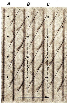
Abb. 128/1. Die Beugung von Röntgenwellen am Kristallgitter. Die an den Ionen der Reihe A des Gitters gebogenen Elementarwellen sind mit den an den Reihen B und C gebogenen nicht in Phase; sie löschen sich gegenseitig aus.
