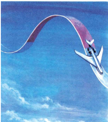
Ablauf eines Parabelfluges (schematisch). Auf dem violett markierten Flugabschnitt herrscht im Flugzeug Schwerelosigkeit
