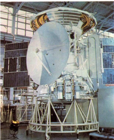
Die sowjetische Planetensonde „Mars-3“ (Masse: 4650 kg) brachte am 2. Dezember 1971 die erste MeßgerätekapSEL auf die Marsoberfläche (Landschaft Phaetontis). Die kugelförmige KapSEL befindet sich unter dem kegelförmigen Eintauchbremschild (oben), im Vordergrund der Parabolreflektor der Richtantenne
