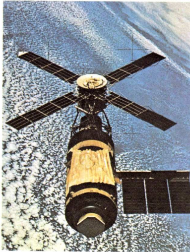
Raumstation „Skylab“ (USA) in der Umlaufbahn, aufgenommen aus dem dritten Zübringer-Raumfahrzeug. Zu erkennen sind der aufgespannte Sonnenschutzschirm, daß die zweite große Solarzelleneinfläche fehlt sowie die Sonnenteleskopenheit mit der Solarzellen-„Windmühle“
