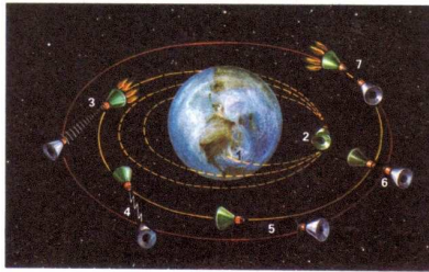
Ablauf eines Rendezvous-Raumfluges in Erdumlaufbahnen (schematisch). 1 Start des folgenden Raumfahrzeugs, 2 Beginn des Aufstiegs in der Annäherungsbahn, 3 Aufnahme der Radarortung zwischen den Raumfahrzeugen, 4 Funkkontakte für den Zielanflug, 5 und 6 zunehmende Annäherung, 7 Einbremsen des aktiven Partners in die Umlaufbahn des Zielobjekts
