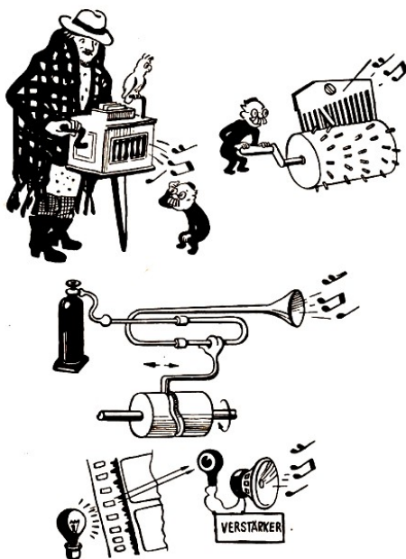
Bild 4.10.: Verschiedene Anlagen zur Aufbewahrung komplizierter Programme (von oben nach unten): eine mit Zapfen versehene Trommel für einen Leierkasten, eine Trommel mit Kurvenstück für kinematische Führung, eine photoelektrische Vorrichtung zur Tonwiedergabe.
