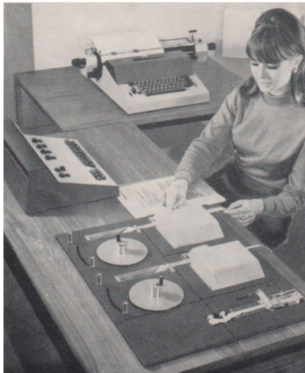
Elektronischer Kleinrechenautomat (Cellatron C 8205 - VEB Kombinat Zentronik, Betrieb Rechelektronik Meiningen/Zella-Mehlis)
