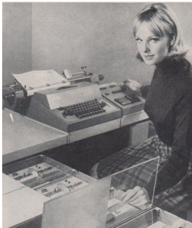
Elektronischer Abrechnungsautomat mit Lochbandein- und -ausgabe (Soemtron 385 — VEB Kombinat Zentronik, Betrieb Büromaschinenwerk Sömmerda)
