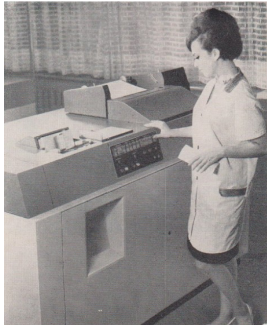
links: Das Sortieren der Lochkarten (Lochkartensortiermaschine Soemtron 434 - VEB Kombinat Zentronik, Betrieb Büromaschinenwerk Sömmerda) rechts: Informationsausgabe (Tabelliermaschine Soemtron 402 - VEB Kombinat Zentronik, Betrieb Büromaschinenwerk Sömmerda)
