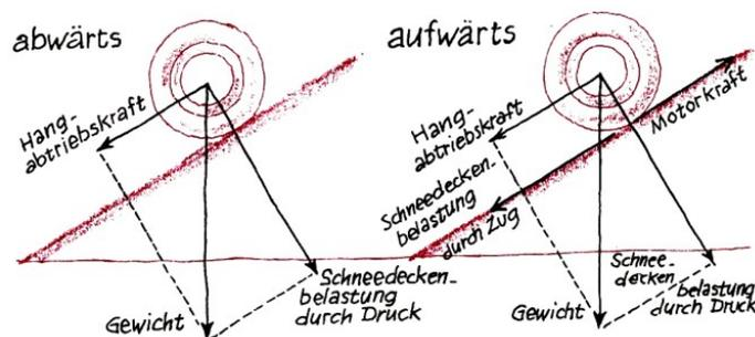
Die Motorkraft wirkt an der Berührungsstelle zwischen Reifen und Schneedecke parallel zur Hangoberfläche und führt zu einer zusätzlichen Zugbelastung, die das Aufreißen der Schneedecke bewirkt.
