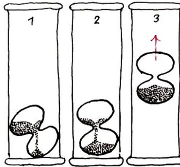
Soll der Schwimmkörper in dieser Lage aufsteigen, muss er die beim Anliegen an der Zylinderinnenwand auftretende Reibung überwinden. Nachdem eine bestimmte Sandmenge in den unteren Teil des Schwimmkörpers gerieselst ist, hat sich der Schwerpunkt des Gefäßes nach unten verlagert, und dabei hat sich die Reibung an der Glaswand verringert. Erst jetzt beginnt der Schwimmkörper zu steigen.
