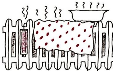
Um die Luftfeuchtigkeit im Zimmer zu erhöhen, hingen an den Heizkörpern keramische Verdunstungsgefäße, die oben offen waren. Da den Studenten die Luft im Zimmer trotzdem zu trocken schien, führten sie Luftfeuchtemessungen durch. Dabei stellten sie fest, dass in einiger Entfernung vom Heizkörper keine Erhöhung der Luftfeuchtigkeit zu verzeichnen war, selbst dann noch nicht, als sie anstelle der normalen Verdunstungsgefäße flache, wassergefüllte Schalen oder nasse Tücher verwendeten.
