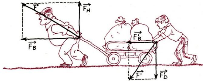
Zerlegt man die beiden Kräfte  $\vec{F}$  und  $\vec{F}'$  der beiden Personen jeweils in zwei Komponenten, so tritt beim Ziehen des Wagens neben der Bewegungskomponente  $\vec{F}_B$  eine Hubkomponente  $\vec{F}_H$  und beim Schieben neben der Bewegungskomponente  $\vec{F}'_B$  eine Druckkomponente  $\vec{F}'_P$  auf (siehe Skizze).
