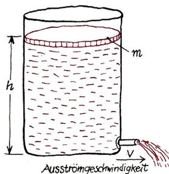
Die unten ausgeströmte Flüssigkeitsmenge fehlt am oberen Ende der Flüssigkeitssäule. Ihre potentielle Energie in der Höhe  $h$  beträgt
