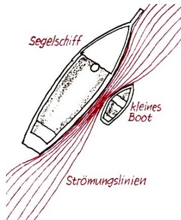
Infolge des Unterdruckes in der Strömungsverengung wird das kleine Boot an das große Segelschiff herangezogen. Man nennt diese Erscheinung hydrodynamisches Paradoxon.
