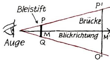
Mit  $\overline{AM} = a$ ,  $\overline{PQ} = b$ ,  $\overline{AM'} = x$  (Entfernung bis zur Brücke),  $\overline{P'Q'} = l$  (Länge der Brücke) gilt dann  $x : a = l : b$  (Strahlensatz), und daraus folgt sofort
