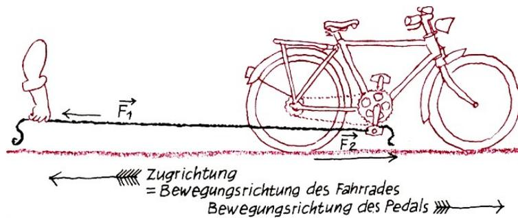
Die gleiche Arbeit wird am Hinterrad verrichtet, jedoch mit einer anderen Kraft vom Betrag  $F_2$ . Damit wird  $F_2 \cdot s_2 = F_2 \cdot n \cdot s_1$ . Lässt man Energieverluste durch Reibung außer acht, so gilt nach dem Energieerhaltungssatz der Mechanik:
