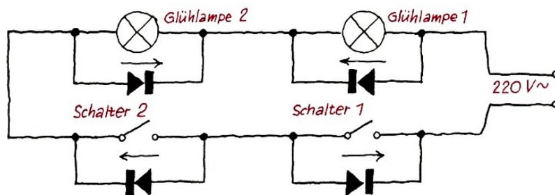
Gleichrichter lassen elektrischen Strom nur in einer Richtung fließen. (Die Durchlassrichtungen sind in der Skizze durch Pfeile gekennzeichnet.)
