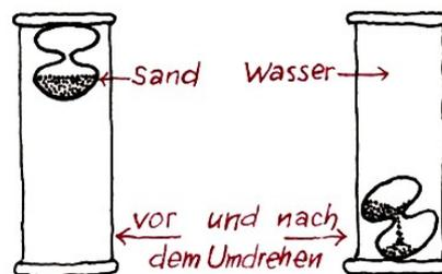
Der Durchmesser dieses Glasgefäßes war nur wenig kleiner als der Innendurchmesser des Zylinders. Die obere und untere Begrenzungsfläche des Glasgefäßes wölbten sich nach außen, und der untere Teil des Glasgefäßes war gerade mit soviel feinem Sand gefüllt, dass das Glasgefäß noch genügend Auftrieb hatte und schwamm.
