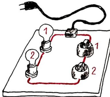
Auf eine Platte aus durchsichtigem Kunststoff sind zwei Fassungen mit 110-V-Glühlampen und zwei normale Ausschalter montiert. Diese vier Teile sind miteinander in Reihe geschaltet (s. Skizze).
