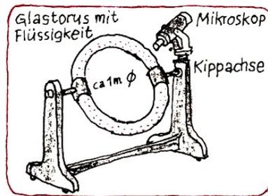
Wie kann man mit diesem drehbaren Torus ohne irgendwelche anderen Hilfsmittel (außer dem Mikroskop) die vier Haupthimmelsrichtungen bestimmen?
