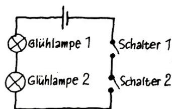
Die Schaltung wird an 20 V Wechselspannung angeschlossen. Beide Schalter stehen zunächst auf "Aus", die Lampen leuchten erwartungsgemäß nicht. Nach gleichzeitigem Einschalten beider Schalter leuchten beide Lampen, wie es den physikalischen Gesetzen entspricht.
