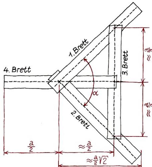
Aus der Skizze entnimmt man sofort ( $a$  bedeutet die Länge eines Brettes), dass die auf die angegebene Weise zusammengebaute Brücke die Gesamtlänge
